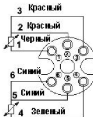
Рисунок И.4 – Трехпроводная схема ТС с двумя ЧЭ (код выводных проводников измерительной вставки 2)
