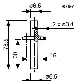
2 адаптера воздуховода и трубы длиной 2 м поставляются с датчиком в комплекте.
