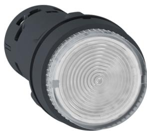
Моноблочная кнопка с подсветкой, пластик, прозрачный, Ø22, встроенный светодиод, пружинный возврат, 24 V AC/DC, 1 НО
